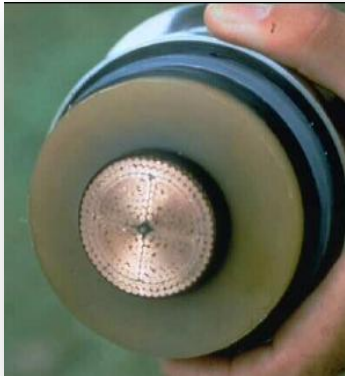
Câble à 225 000 volts
